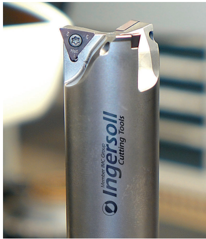
3 Mithilfe dieses schnell verfügbaren Schlichtfräasers aus dem Ingersoll-Extreme-Programm – hier auf einem Werkzeug-Vor-einstellgerät – wurden alle Anforderungen erfüllt (© Ingersoll Werkzeuge)
